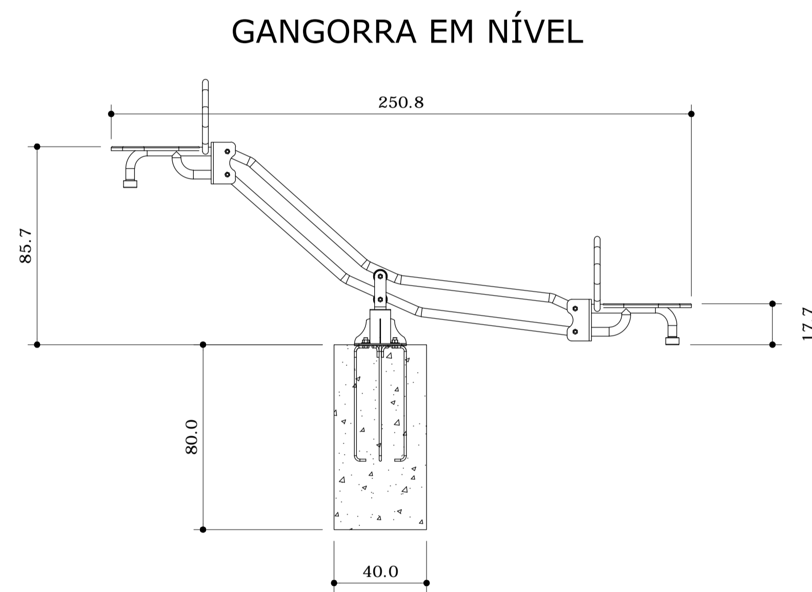
API - CORTE ESQUEMÁTICO BLOCOS DE CONCRETO esc.: 1:25
